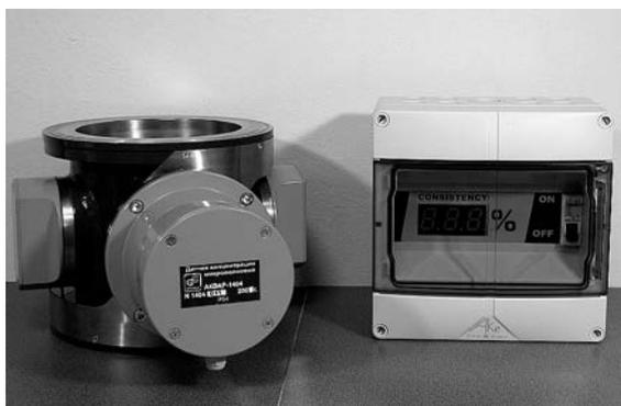
Рисунок 2 – Микроволновый датчик концентрации бумажной массы в водно-бумажной пульпе «А-344»
