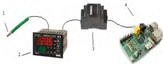
Рисунок 2 – Структурная схема измерения температуры: 1 – датчик температуры (термопара), 2 – измеритель-регулятор TPM210, 3 – автоматический преобразователь интерфейса AC4, 4 – мини-компьютер
