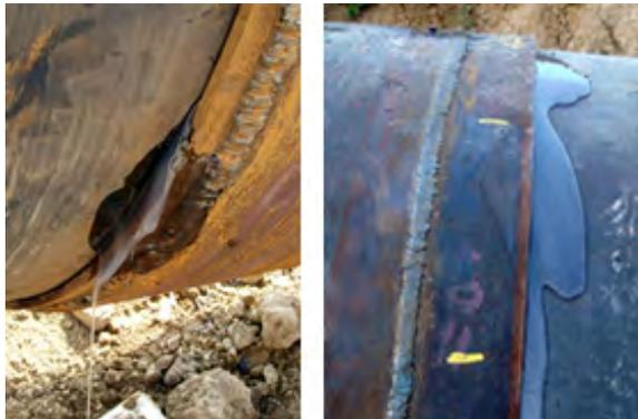
Рисунок 1 – Течь самотвердеющего вещества по сварным швам муфты
