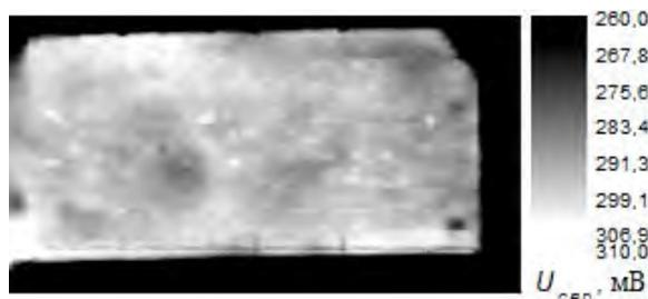
Рисунок 1 – Электропотенциальное изображение распределения РВЭ поверхности алюминиевого сплава АМГ-2, обработанной по технологии алмазного наноточения, класс чистоты 14
