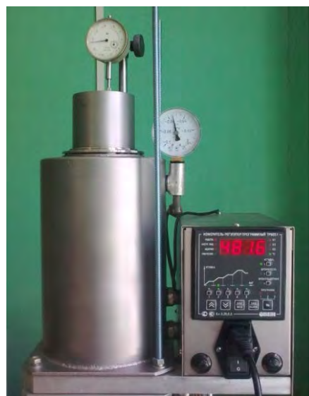
Рисунок 2 – Экспериментальная установка электроимпульсного прессования
