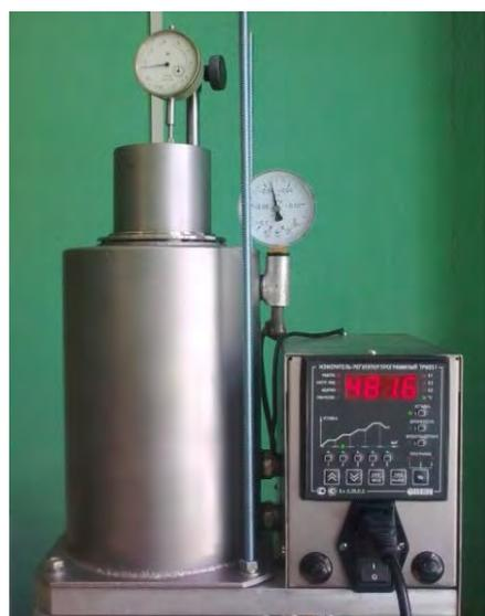
Рисунок 2 – Экспериментальная установка электроимпульсного прессования
