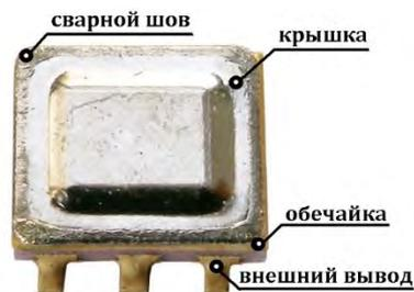
Рисунок 2 – Внешний вид керамического корпуса
