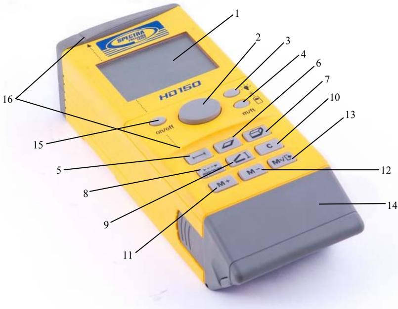
Рис. 9.3. Внешние элементы лазерного дальномера HD150:
