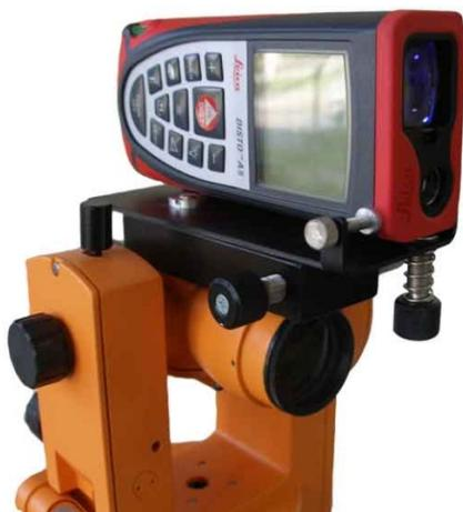
Рис. 9.2. Пример крепления лазерной рулетки к теодолиту Т30
