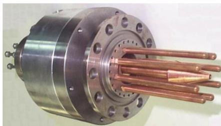
Рисунок 1 – Разрядное устройство МПК – КГ
