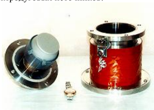
Рисунок 1 – Электродуговой источник металлической и углеродной плазмы (катодная и анодная части) с магнитным удержанием дуги на торце катода и магнитной фокусировкой плазменного потока
