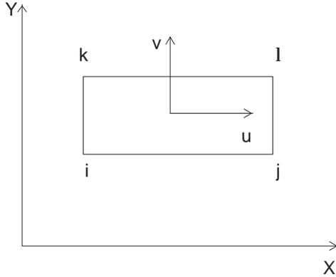
Рис.2 Локальная система координат в элементе
