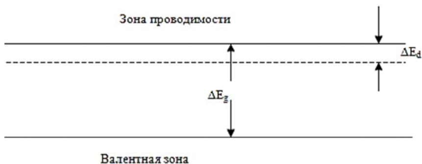
Рис. 9. Энергетическая схема полупроводника n -типа
