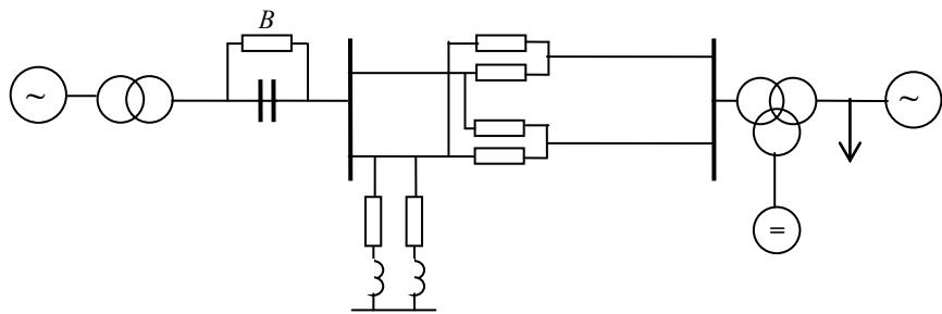
*Рис. 3. Схема системы передачи с послеаварийной продольной компенсацией
