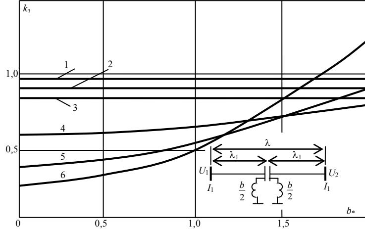
*Rис. 1.* Зависимость пропускной способности ЛЭП с учетом потерь активной мощности от проводимости шунтирующих ректоров
