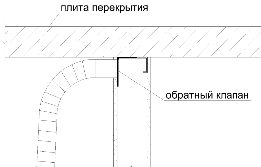
Рисунок 4 – Схема устройства обратного клапана
