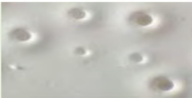
Рис. 2.33. Пена (дыры, оставшиеся в пленке после высвобождения воздуха в процессе формирования пленки, не выровнялись)
