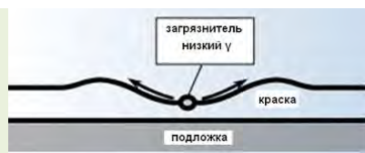
Рис. 2.31. Образование кратеров (гидрофобный загрязнитель инициирует течение жидкости)
