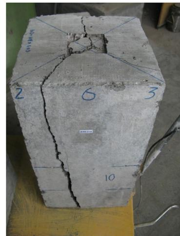
Рисунок 2 – Характер разрушения образца при передаче нагрузки через штамп сечением 90×90 мм: а) - с применением поперечного армирования; б) - без применения поперечного армирования.
