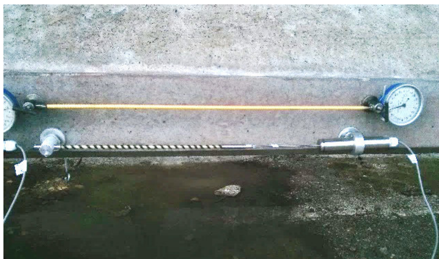
Рисунок 5 – Установленные измерительные средства на испытываемой балке
