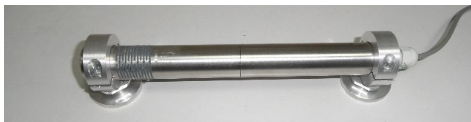
Рисунок 3 – LVDT датчик с направленным штоком ПЛП-2-П
