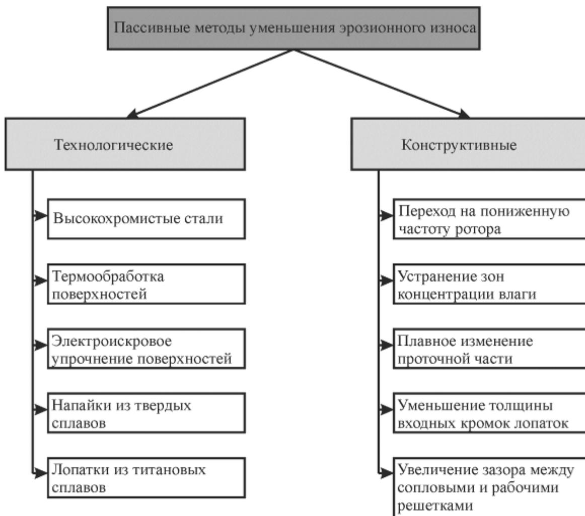
Рисунок 2 – Пассивные методы уменьшения эрозионного износа
