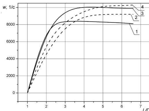
Рис. 2. Изменение угловой скорости вращения частицы полистирола ( $\rho_a = 1150 \text{ кг/м}^3$ ;  $a = 2 \text{ мм}$ ) по длине элемента:  $W_z = 20 \text{ м/с}$ ;  $D = 0,15 \text{ м}$ ;  $\beta = 35^\circ$ ; 1 – касательная составляющая (расчетная); 2 – касательная составляющая ( $\omega = v/a$ ); 3 – осевая составляющая (расчетная); 4 – осевая составляющая ( $\omega = v/a$ )
