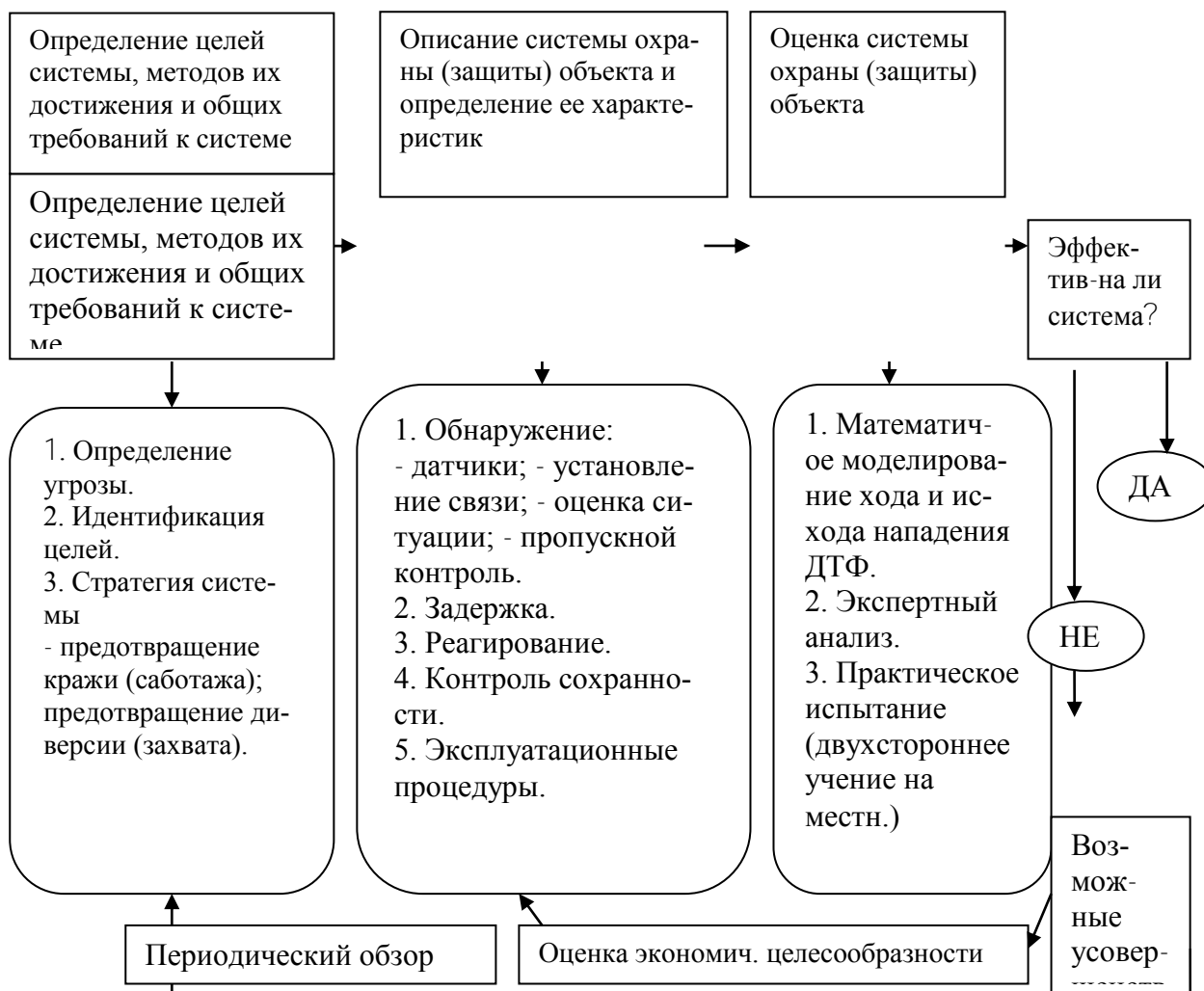
Рисунок 2 – Структурно-логическая схема содержания и последовательности процесса «анализа эффективности системы охраны объекта»
