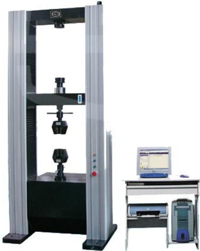
Рисунок 1.12. Внешний вид испытательной разрывной машины с ПЭВМ
