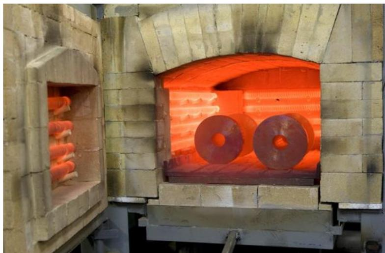
Рисунок 1.21. Термическая обработка деталей
