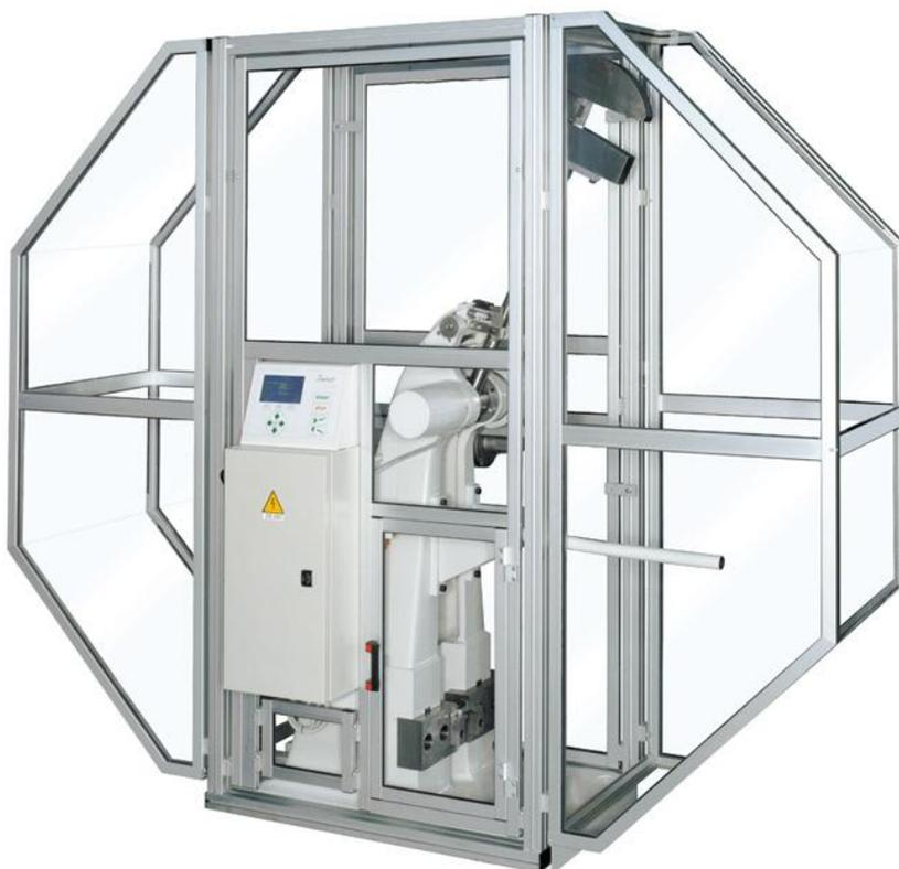
Рисунок 1.19. Внешний вид копра для проведения испытаний образцов на ударную вязкость
