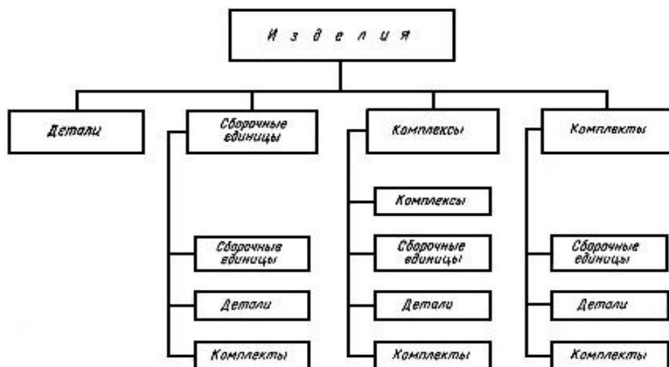
Рисунок 1- Схема принципиально возможной структуры видов изделий
