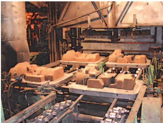
Рис. 2. Этап ранее действующей на ОАО «МТЗ» технологии изготовления стержней с применением тепловой сушки
