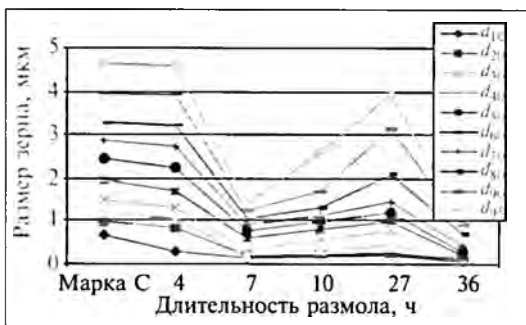
Рис. 5. Зависимость размера зерна порошка MoSi 2 (Марка С) различных фракций от длительности помола
