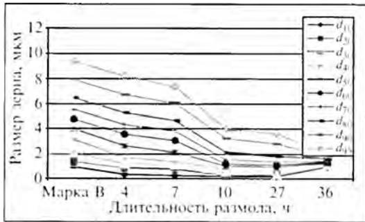
Рис. 3. Зависимость размера зерна порошка MoSi 2 (Марка В) различных фракций от длительности помола
