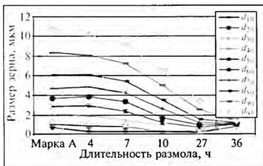
Рис. 1. Зависимость размера зерна порошка MoSi 2 (Марка А) различных фракций от длительности помола
