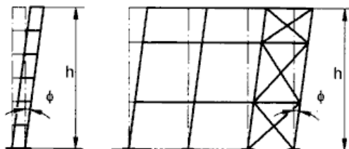
Рис. 3.3. Эквивалентные несовершенства при поперечном отклонении
