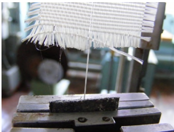
Рис. 3.7. Образец ткани в момент испытания при вытаскивании нити
