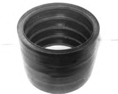
Рис. 1.18. Модель интегральной цилиндрической оболочки с тавровыми шпангоутами
