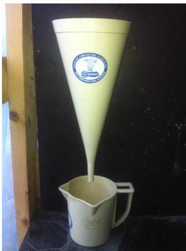
Рисунок 4. – Вискозиметр «Воронка Марша»
