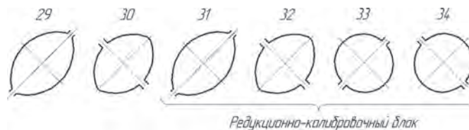
Рис. 7. Схема калибровки последних шести проходов прокатки катанки диаметром 5,5 мм (предлагаемый вариант)
