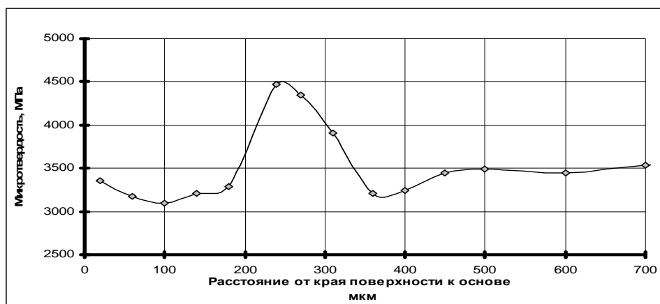
Рисунок 3 – График микротвердости образца с маркировкой 2
