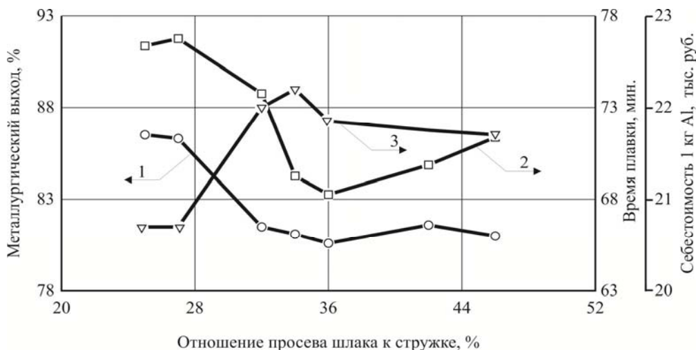
Рисунок 3 – Влияние отношения просева шлака к стружке на металлургический выход (1), длительность плавки (2) и себестоимость получаемого сплава (3)
