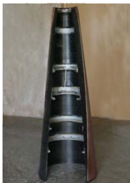
Рис. 6.8. Силовая оболочка со шпангоутами из АМГ-6
