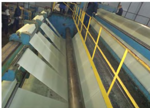
Рис. 5.10. Намотка тканью Т-13 цилиндрической оболочки
