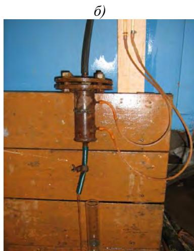
Рисунок 4.7 – Вертикальный фильтрационно-суффозионный прибор:
