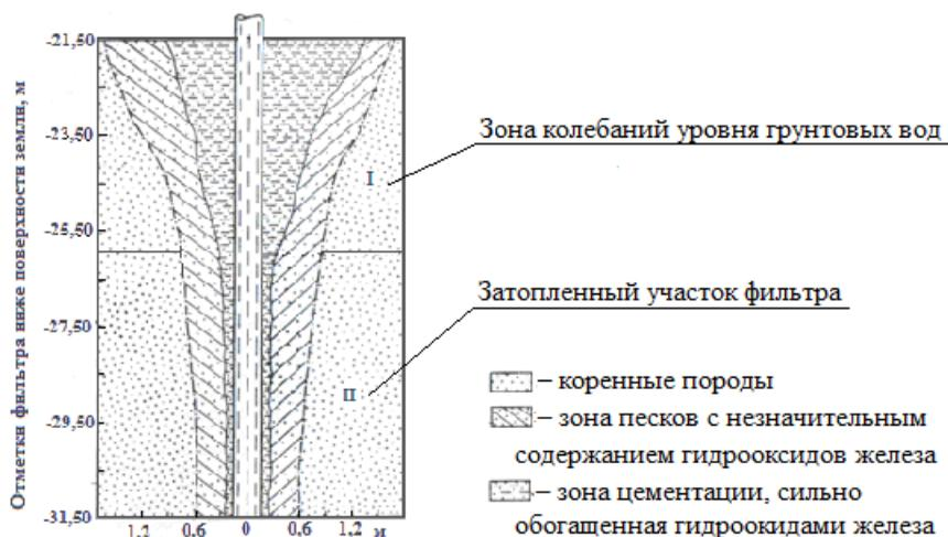
Рисунок 1.6 – Зона измененной проницаемости вокруг фильтров водопонизительных скважин Волгоградской ГЭС [7]
