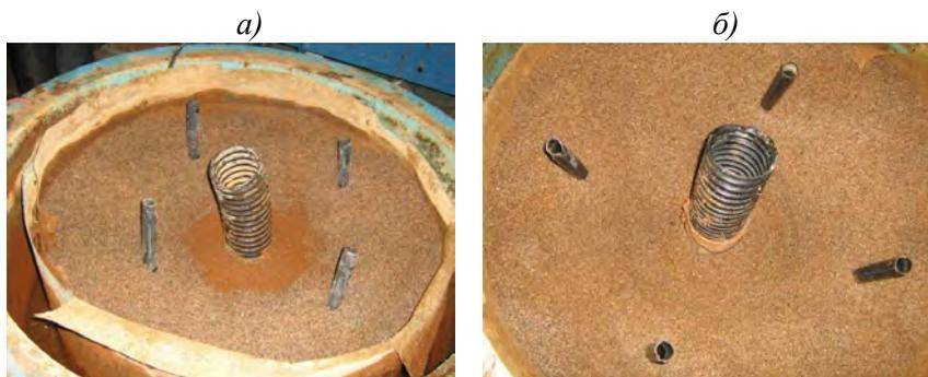
Рисунок 4.11 – Прифильтровая зона модели водозаборной скважины [98]:
