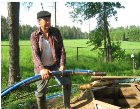
Рисунок 6.10 – Общий вид гидроэлеватора с подсоединенными шлангами перед спуском в скважину
