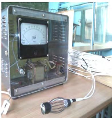
Рисунок 6.12 – Общий вид прибора для обнаружения мест пескования скважин
