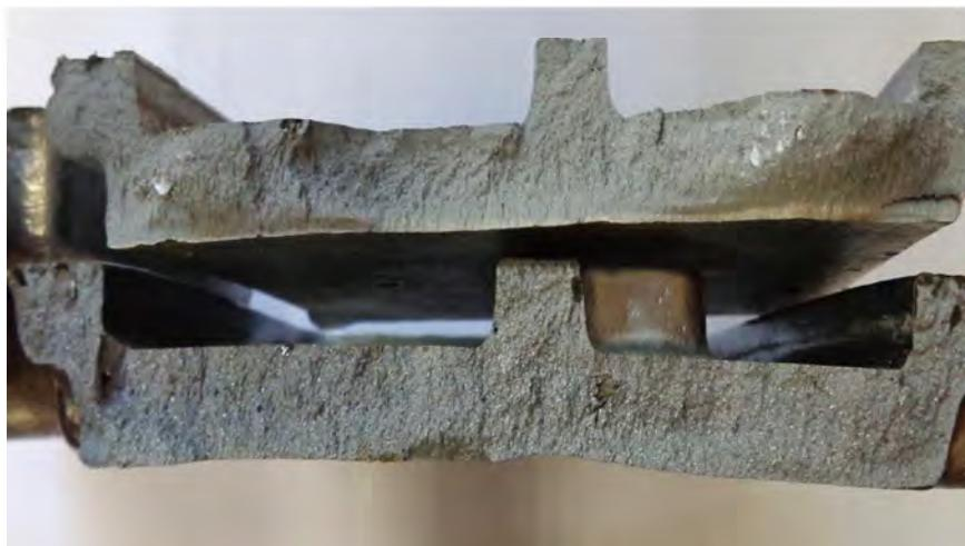
Рис. 4.21. Излом отливок «Крышка», полученных из разных сплавов методом литья в кокиль: сверху – отливка, полученная из дисперсно-упрочненного эвтектического силумина с использованием добавок композиции  $Al-1\%Ti/10\%SiC$ ; снизу – отливка из сплава АК12, приготовленного по традиционной технологии сплавления алюминия с кристаллическим кремнием
