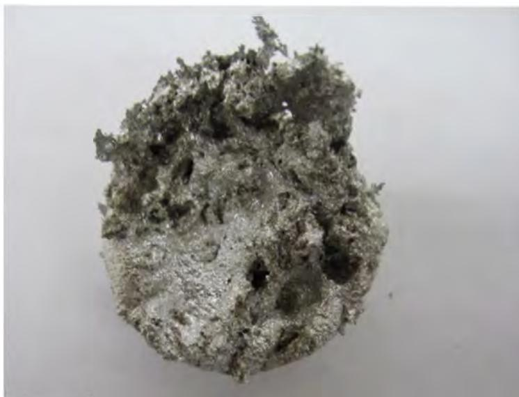
Рис. 2.42. Внешний вид фрагмента композиционной суспензии  $Al/10\%SiO_2$  после затвердевания
