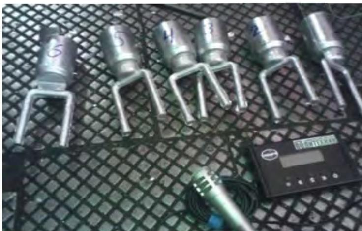
Рис. 5.25. Образцы U-образных технологических проб сплава АК12М2Мг для акустического анализа
