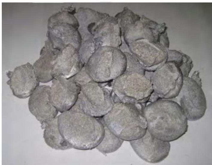
Рис. 2.31. Затвердевшие массы АКС системы  $Al-30\%SiO_2$ , полученной методом гетерофазного совмещения компонентов композиции, после ТВО при температуре 850 °С в течение 45 мин
