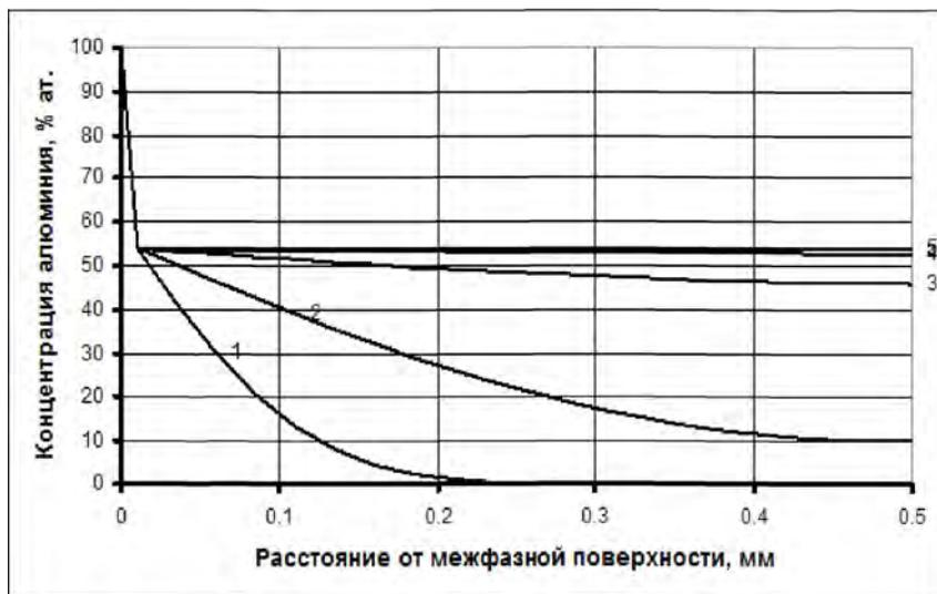
Рис. 2.36. Распределение концентрации алюминия по сечению оксидной фазы кремнезема при времени выдержки композиции 4000 с для различных значений коэффициента диффузии алюминия: 1)  $D=10^{-8}$  см<sup>2</sup>/с; 2)  $D=10^{-7}$  см<sup>2</sup>/с; 3)  $D=5 \cdot 10^{-7}$  см<sup>2</sup>/с; 4)  $D=10^{-6}$  см<sup>2</sup>/с; 5)  $D=5 \cdot 10^{-6}$  см<sup>2</sup>/с
