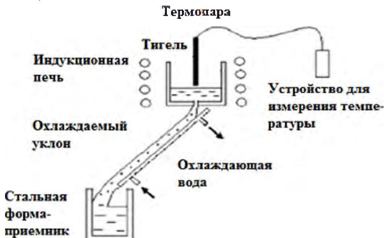
Рис. 1.18. Принципиальная схема CS-процесса, представленная в работе [135], по данным работы [136]
