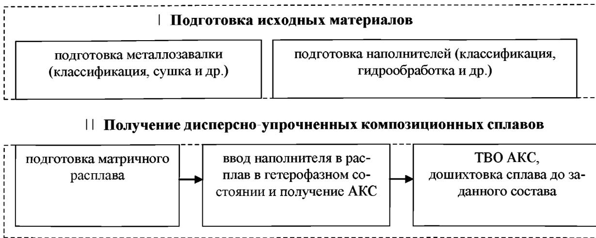
Рис. 2.2. Технологическая схема синтеза дисперсно-упрочненных композиционных сплавов и модифицирующих лигатур на основе алюминия, содержащих дисперсные частицы тугоплавких соединений
