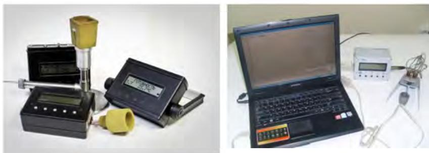
Рис. 5.1. Микропроцессорные регистрирующие устройства для термического анализа с автономным питанием
