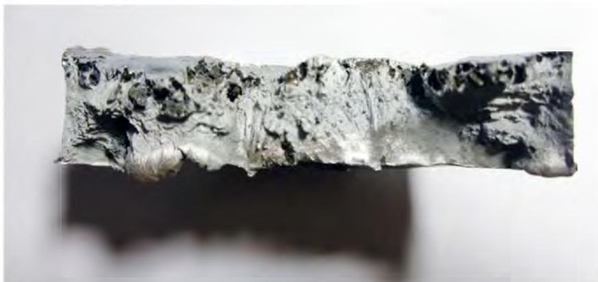
Рис. 4.25. Излом технологической пробы АКС, полученного из композиционной суспензии состава  $Al-9,4\%Si/7,5\%SiO_2$  после ТВО в режиме «нагрев до  $850\text{ }^\circ\text{C}$ –изотермическая выдержка 45 мин» без рафинирующей обработки
