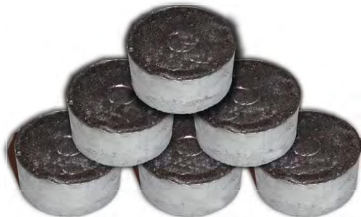
Рис. 4.26. Образцы заготовок, полученные из дисперсно-упрочненных заэвтектических силуминов, с высоким содержанием армирующих фаз ( $50\% Al_2O_3$  и  $10\% SiC$ )
