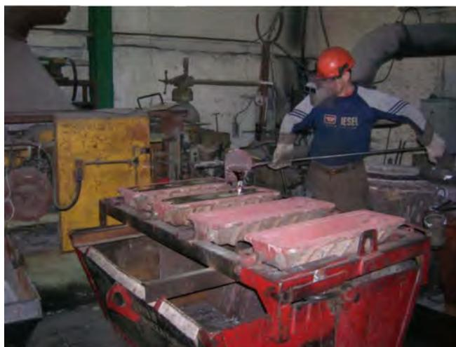
Рис. 4.3. Разливка в чушки сплава АК7, полученного с использованием  $Al-Si$  лигатуры, синтезированной из алломатричной композиционной суспензии с использованием кремнезема, на литейном участке гродненского цеха ОАО «Белцветмет»
