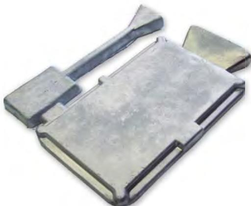
Рис. 4.19. Отливка «Крышка», полученная методом литья в кокиль из дисперсно-упрочненного эвтектического силумина с использованием добавок композиции  $Al-1\%Ti/10\%SiC$
