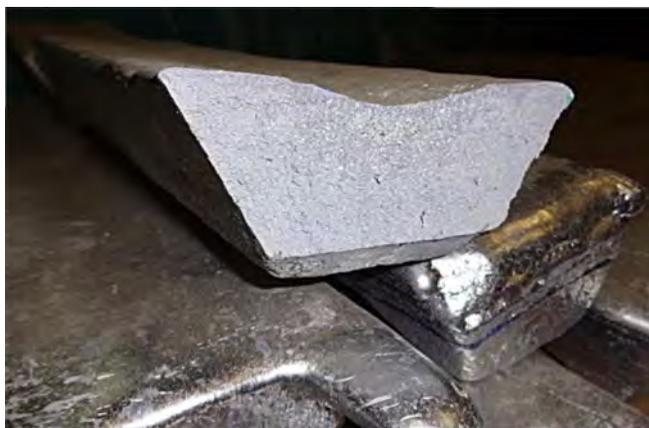
Рис. 4.18. Излом чушки силумина эвтектического состава  $Al-12\%Si$ , полученного из композиционной суспензии  $Al/SiO_2$  с использованием кварцевого песка
