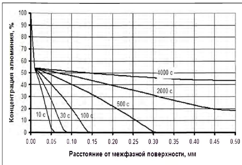
Рис. 2.38. Распределение концентрации алюминия по сечению оксидной фазы АКС при значении коэффициентов диффузии алюминия через мономолекулярный  $\text{Al}_2\text{O}_3$ -слой  $D_{\text{Al}_2\text{O}_3}=6,4 \cdot 10^{-7} \text{ см}^2/\text{с}$  и в кремнеземе  $D_{\text{Si}_2\text{O}_2}=10^{-10} \text{ см}^2/\text{с}$  в различные моменты времени выдержки композиции
