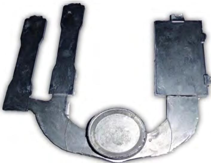
Рис. 4.24. Технологическая проба, полученная литьем под высоким давлением из дисперсно-упрочненного силумина эвтектического состава после рафинирующей обработки, с использованием добавок композиции  $Al-1\%Ti/10\%SiC$
