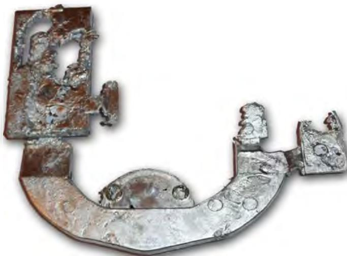
Рис. 4.23. Технологическая проба, полученная литьем под высоким давлением из композиционной суспензии  $Al-1\%Ti/10\%SiC$
