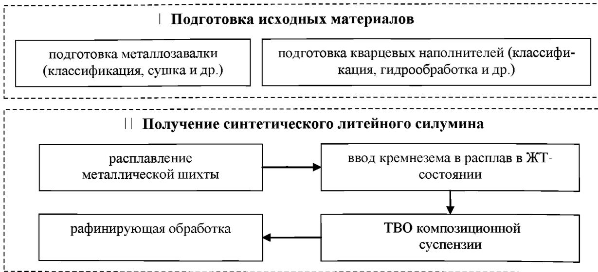
Рис. 2.3. Технологическая схема получения СЛС с использованием кварцевых материалов [159-162]
