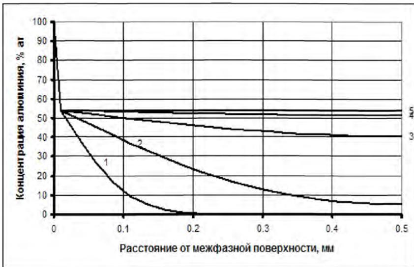
Рис. 2.35. Распределение концентрации алюминия по сечению оксидной фазы кремнезема при времени выдержки композиции 3000 с для различных значений коэффициента диффузии алюминия: 1)  $D=10^{-8}$  см<sup>2</sup>/с; 2)  $D=10^{-7}$  см<sup>2</sup>/с; 3)  $D=5 \cdot 10^{-7}$  см<sup>2</sup>/с; 4)  $D=10^{-6}$  см<sup>2</sup>/с; 5)  $D=5 \cdot 10^{-6}$  см<sup>2</sup>/с
