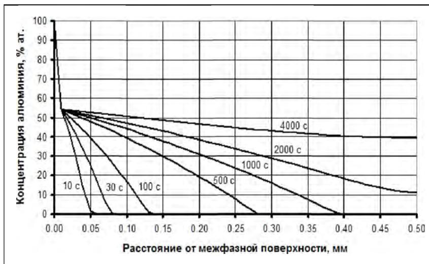
Рис. 2.39. Распределение концентрации алюминия по сечению оксидной фазы АКС при значении коэффициентов диффузии алюминия через мономолекулярный  $\text{Al}_2\text{O}_3$ -слой  $D_{\text{Al}_2\text{O}_3} = 6,4 \cdot 10^{-7} \text{ см}^2/\text{с}$  и в кремнеземе  $D_{\text{Si}_2\text{O}_2} = 10^{-17} \text{ см}^2/\text{с}$  в различные моменты времени выдержки композиции
