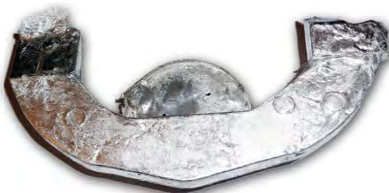
Рис. 4.22. Технологическая проба, полученная литьем под высоким давлением из АКС, синтезированного из композиционной суспензии состава  $Al-9,4\%Si/7,5\%SiO_2$  после ТВО в режиме «нагрев до  $850\text{ }^\circ\text{C}$ –изотермическая выдержка 45 мин» без финишной рафинирующей обработки композиционной суспензии
