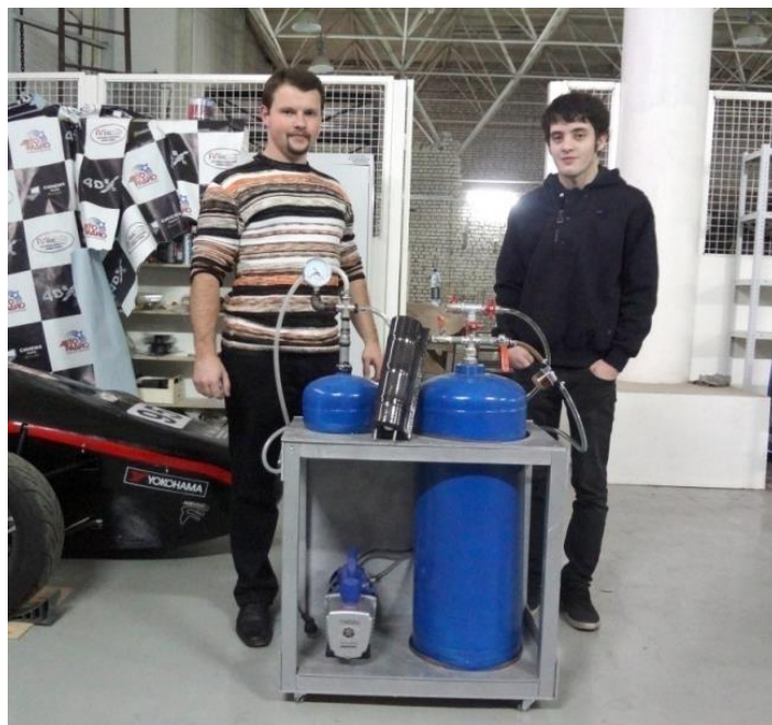
Рис. 2. Установка для вакуумной инфузии, созданная участниками СКБ «Формула Студент»
