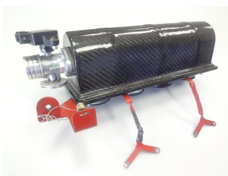
Рис. 3. Ресивер впускной системы, выполненный на основе углеродного волокна Применение углеродного волокна в качестве основного материала конструкции ресивера впускной системы позволило без потери прочностных качеств добиться общего сниже-
