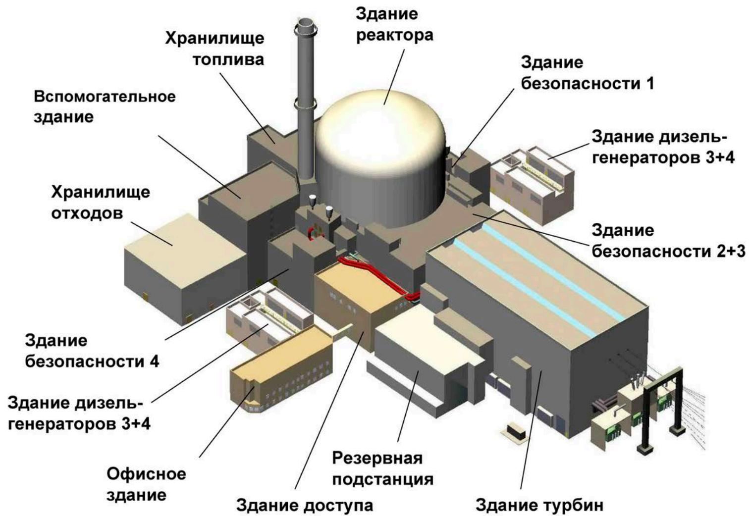
Рисунок 2.1 План электростанции Areva Nuclear Power [8].
