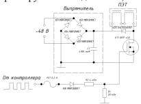
контроллер, сделав контур управления ПЭТ замкнутым. В основу алгоритма управления транзисторным ключом положена зависимость тормозного момента ПЭТ от скорости движения автомобиля по передачам. Величина момента сопротивления, развиваемого порошковым электромагнитным тор-
