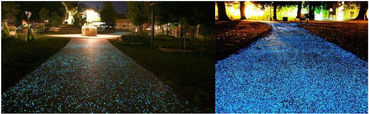
Рисунок 1 – Светоизлучающий бетон нового поколения
