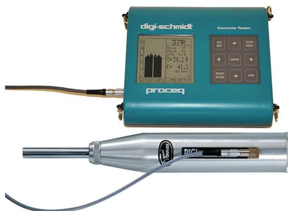
Рисунок 1 – Электронный склерометр Digi-Schmidt
