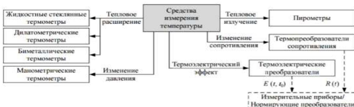
Рисунок 1 – Классификация средств измерения температуры
