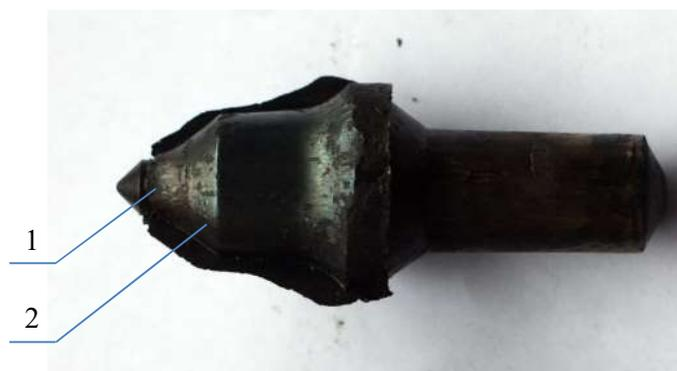
Рисунок 5 – Фото заготовки резца после деформации
