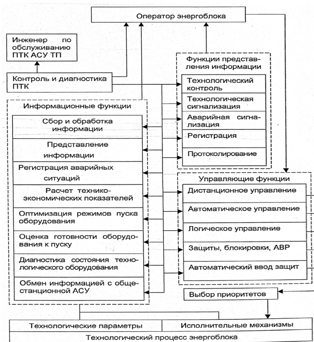
Рисунок 4.1 – Функциональная схема АСУ ТП блока
