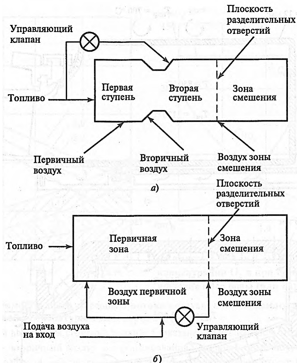
Рисунок 3.14 – Схемы разделения рабочего тела в КС по топливу (а) и по воздуху (б).
