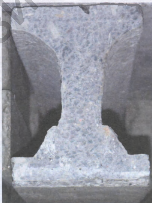
Рис. 11. Фрагмент ребра, вырезанного из плиты, для определения фактической прочности бетона на растяжение
