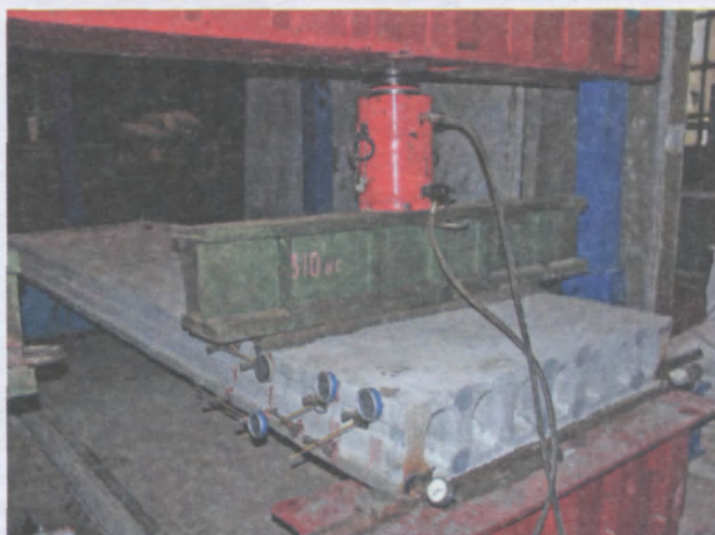
Рис. 8. Общий вид испытаний многопустотных плит на сдвиг
