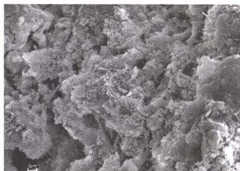
**Рисунок 10 - Поверхность скола образца, содержащего 0,8% гиперпластификатора Стахемент-2000**
