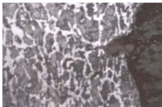
Рисунок 3 - Характерный вид зарождающейся начальной серповидной трещины у наиболее напряженного витка резьбы (а) и вид зарождающейся трещины в корне наиболее напряженного витка резьбы (б)
