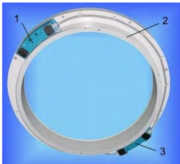
Рис. 3. Синхронный сегментный двигатель RSMS-M36: 1, 3 – неподвижные сегменты; 2 – подвижный ротор
