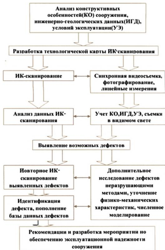
Рисунок 6 - Блок-схема ИК-сканирования пролетного строения
