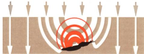
Рисунок 4 - Схема выявления дефекта при активном ИК-термографировании
