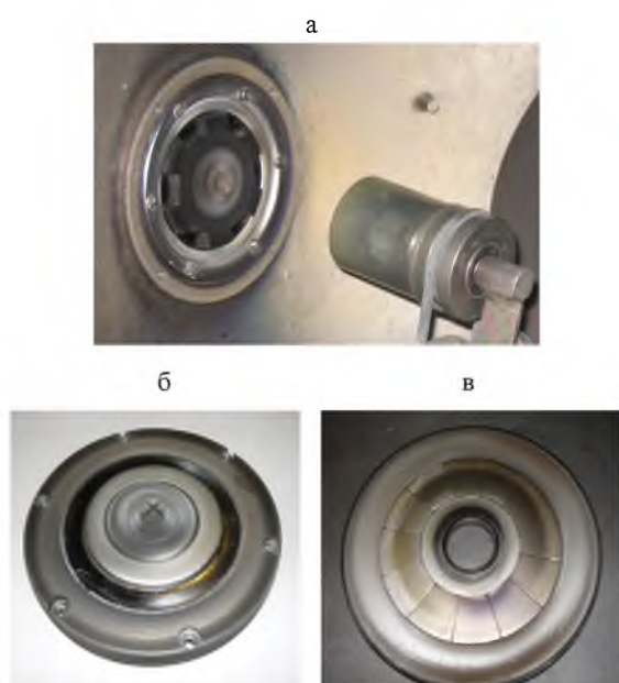
Рис. 1. Перемешивающее устройство и комбинированные катоды: кремний – углерод (а); молибден – кремний (б); кобальтовый сплав ЭП 131 – никель (в)
