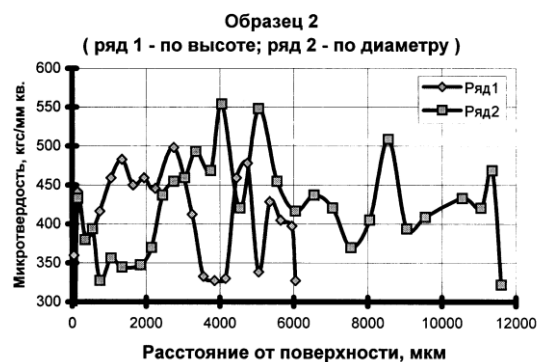
Рис. 2. Микротвердость образца на основе кобальта
