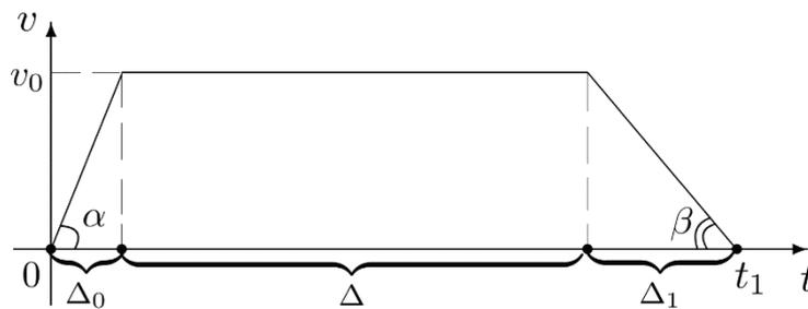
Рис. 1. Зависимость модуля максимальной скорости от времени
