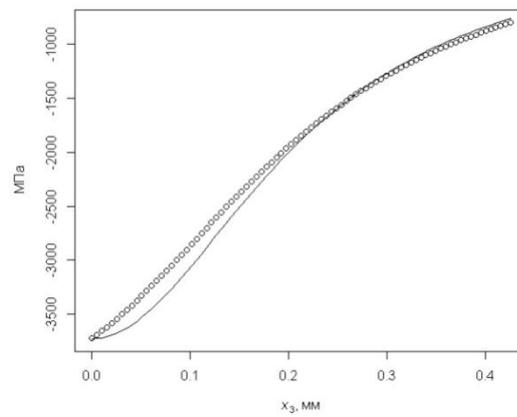
Рис. 4. Распределение напряжения  $\sigma_{33}^{(3)}$  вдоль оси  $Ox_3$
