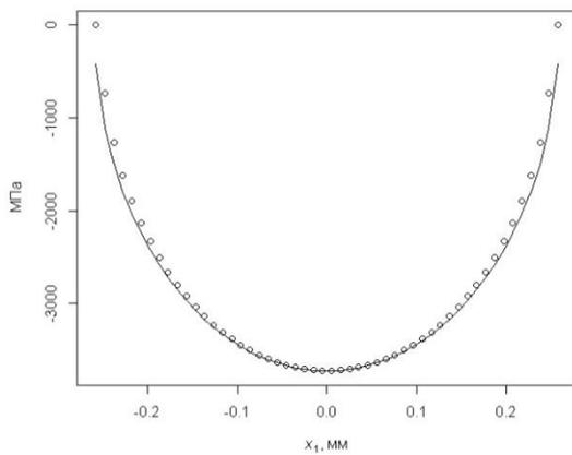
Рис. 3. Распределение напряжения  $\sigma_{33}^{(3)}$  вдоль оси  $Ox_1$
