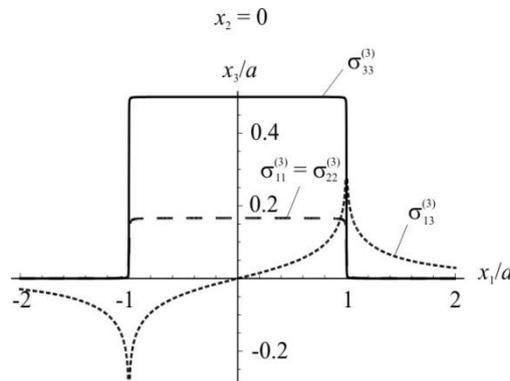
Рис. 1. Распределение вдоль осей  $x_1$  и  $x_3$  некоторых компонент тензора напряжений, отнесенных к величине усилий  $p_0$
