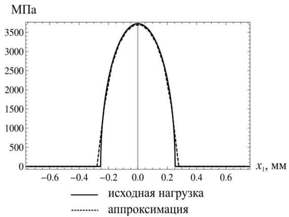
Рис. 2. Аппроксимация непрерывного распределения граничной нагрузки
