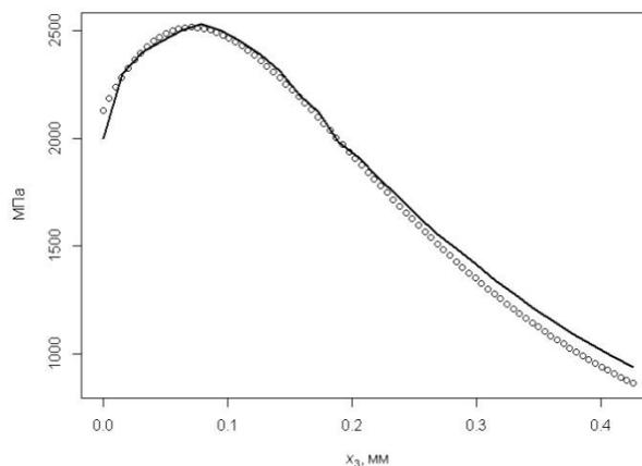
Рис. 5. Распределение эквивалентных напряжений (по Мизесу) вдоль оси  $Ox_3$
