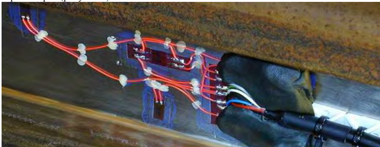
Рис. 4. Установка тензорезисторов на раме автомобиля
