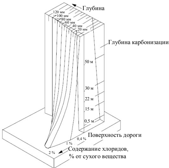
Рис. 7. Зависимость глубины проникновения хлора от высоты вблизи дороги [9]
