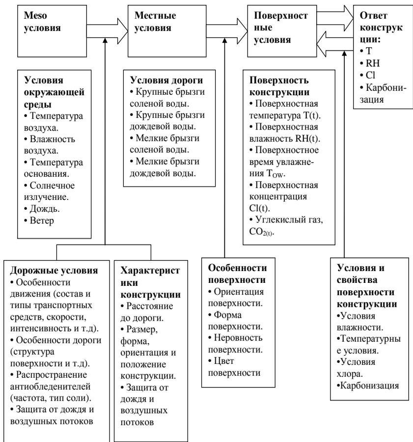
Рис. 2.34. Качественная модель для внешних воздействий на железобетонные конструкции
