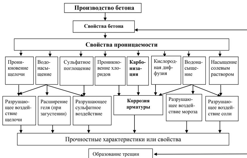
Рис. 1.1. Деградация железобетонных конструкций
