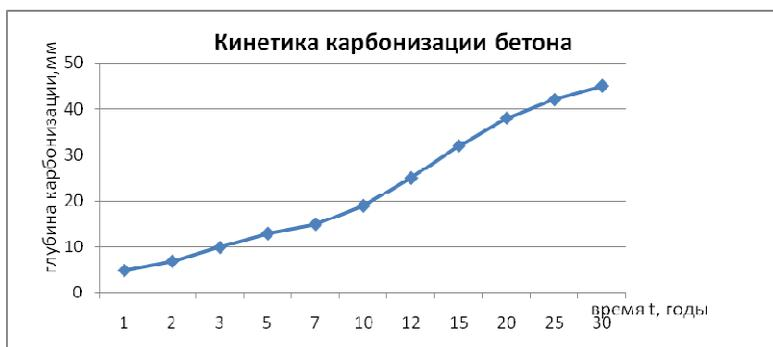
Рис. 1.17. Кинетика карбонизации бетона по объекту в зоне Персидского залива
