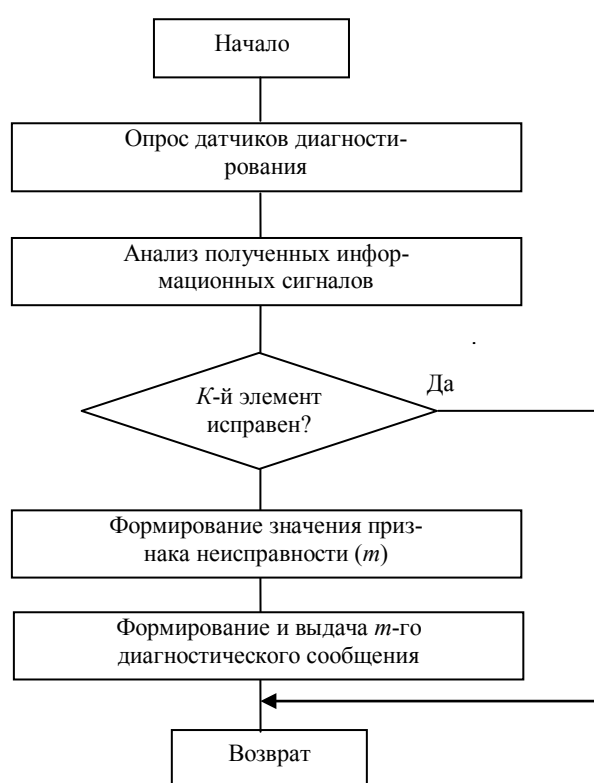
Рис. 3. Укрупненная блок-схема алгоритма бортового диагностирования технических средств и объекта диагностирования
